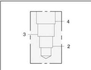
Typische Einschraubventile für diese Gehäuse
