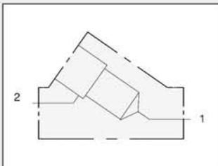
Typische Einschraubventile für diese Gehäuse
