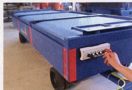
Über das Bedientableau an der Stirnseite des Wagens steuert der Bediener alle Bewegungsabläufe.
