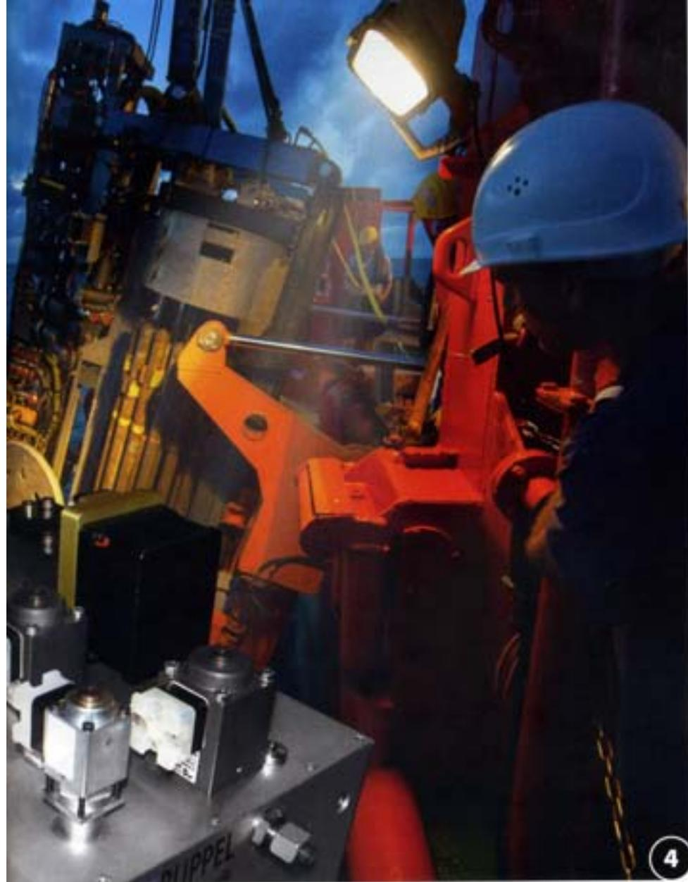
Gründen des Umweltschutzes kommt als Druckmedium eine biologisch abbaubare Flüssigkeit zum Einsatz. In der hydraulischen Steuerung werden sowohl Schwarz-Weiß- als auch Servoventile eingesetzt.
