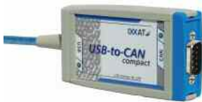
Abbildung 10: USB-to-CAN-Adapterkarte (Moog-Bestellnr.: C43094-001)
