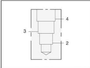
Typische Einschraubventile für diese Gehäuse
