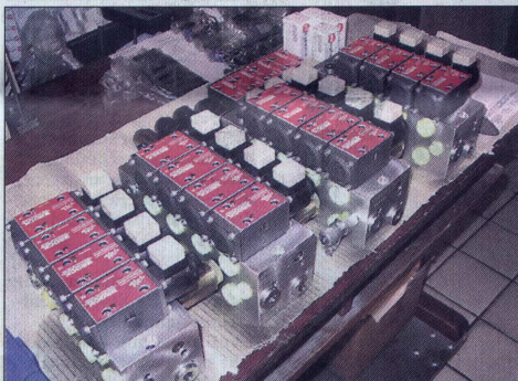
In Bakede produziert: Hydrauliksteuerblöcke für Kehrfahrzeuge.
